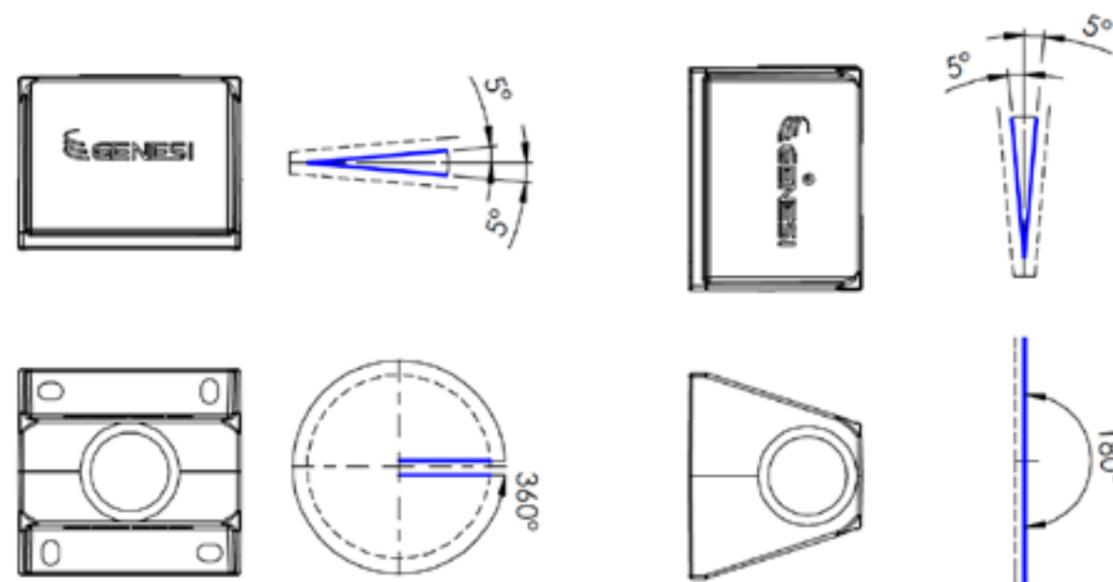
BUMP73 permette un angolo di lavoro di 360° con fissaggio a pavimento e di 180° con fissaggio a parete
